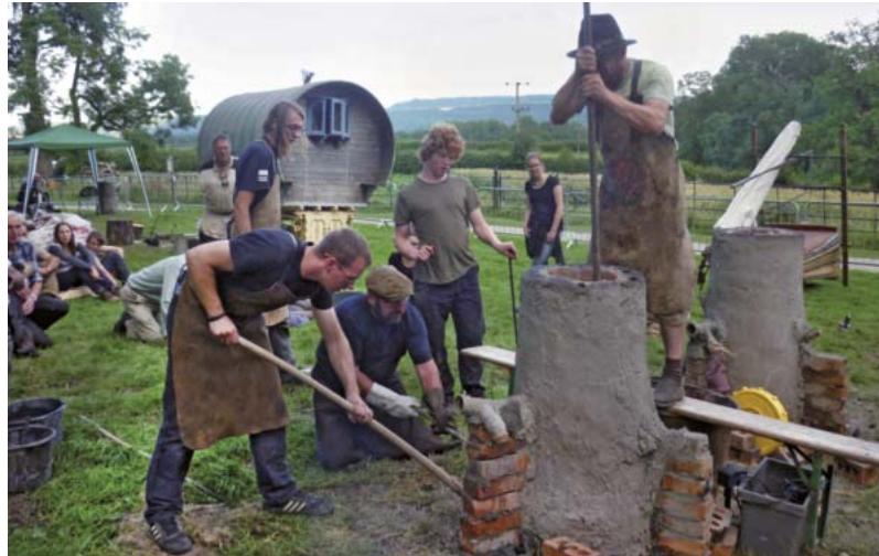
Der Rennofen wird geöffnet. Mit einer Eisenstange versucht Georg Petau die Luppe zu lösen, und die Mitwirkenden des 9. Symposiums sind gespannt, ob sie brauchbar ist
