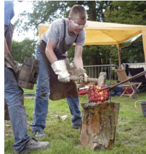
Nach dem Verdichten geht es mit Zuschlaghammer und Amboss weiter
